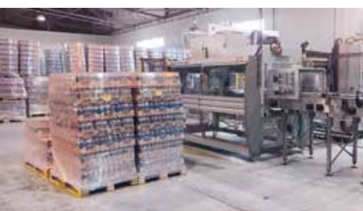
хвостовая часть линии по производству пэт-бутылок производительностью 24.000 Б/Ч
