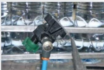
La instalación de la lubricación de las cintas Smiline es un sistema automático por medio de toberas que permite reducir drásticamente el nivel de ruido, los costes de la gestión y las operaciones de limpieza.
