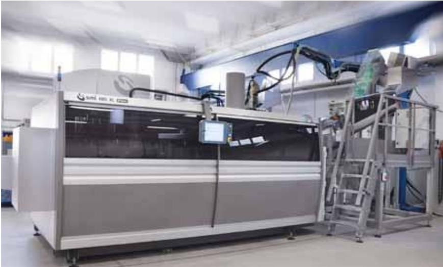
calentamiento de preformas está integrada con la sección de moldeado por estirado-soplado en un solo módulo.
